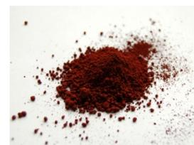
Figura 6.02. Óxido de Hierro(III) pulverizado.
